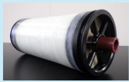
図2 : 膜エレメント (10cm径, 20cm長) の外観
