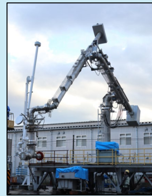
図1：世界で初めて開発した液化水素用ローディングアーム
