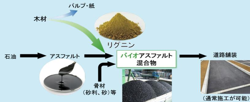
図1 : バイオアスファルト混合物利用のイメージ
