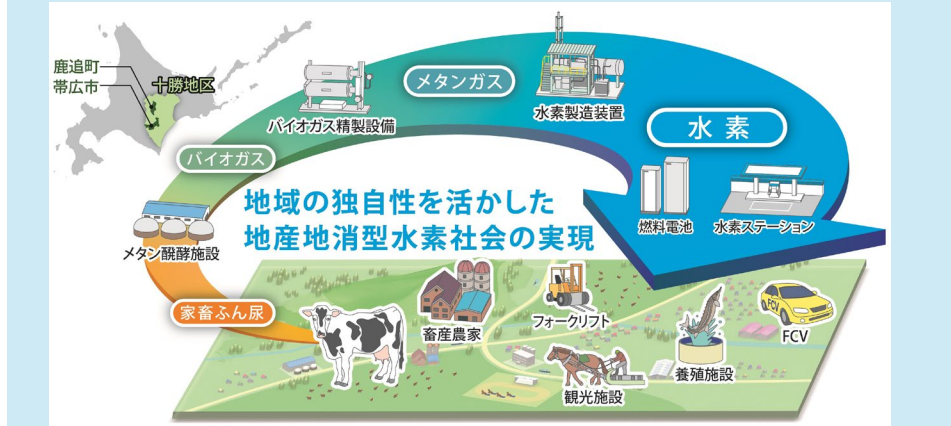
図1：事業概要イメージ（家畜ふん尿をメタン発酵させ精製し水素を製造・利用）
