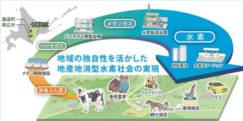
図1：事業概要イメージ（家畜ふん尿をメタン発酵させ精製し水素を製造・利用）
