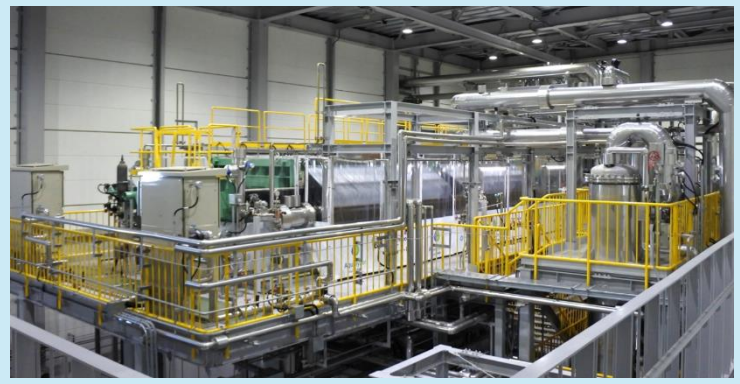
図 福島水素エネルギー研究フィールド（FH2R）向け大型水電解システム外観
