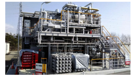
図２：再生可能エネルギー由来の水素を原料とするアンモニアの合成実証試験装置（産総研福島再生可能エネルギー研究所）
