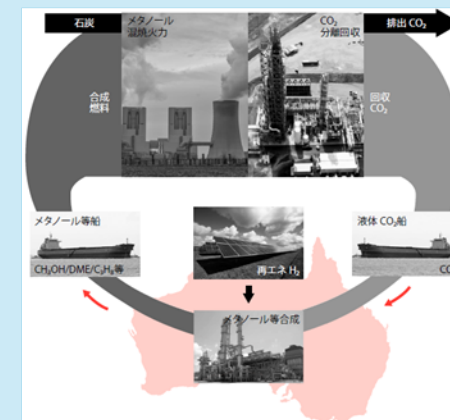
図2：CO2回収型石炭・メタノール混焼火力によるカーボンリサイクルエネルギーシステム 公的資金の活用状況（提供元、資金名、活用期間、スキーム等）
