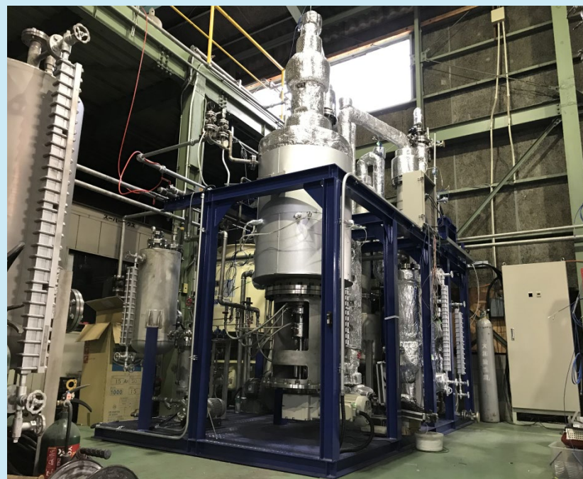
図1：バイオジェット燃料製造実証装置
