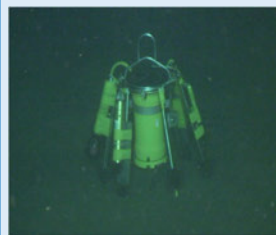
ADCP、CTD、 濁度計、溶存酸素計
