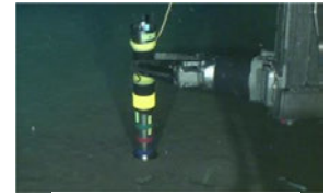
地中温度計の設置
