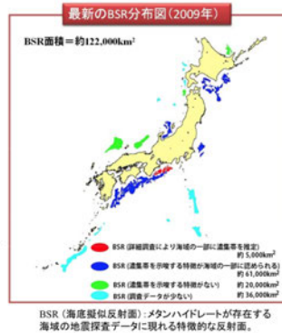
BSR (海底疑似反射面)メタンハイドレートが存在する海域の地震探査データに現れる特徴的な反射面。
