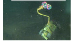
海底に設置した海底水温計
