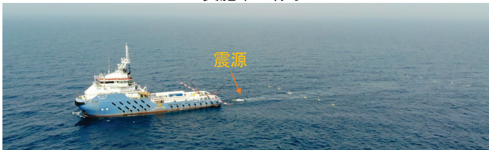
HR3D実施中の様子
