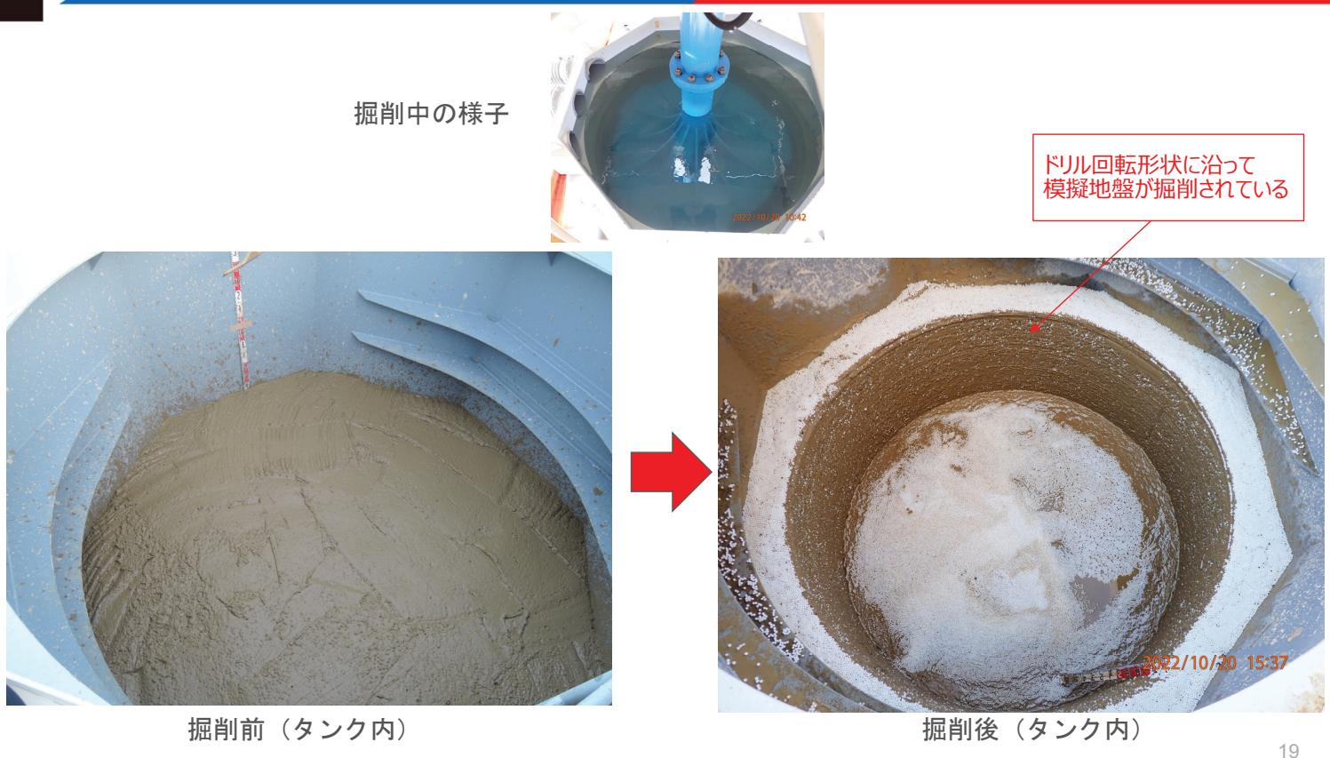
掘削ドリルが模擬地盤を上手く掘削できることを確認
