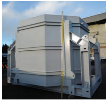
大型氷の作製用のタンク (直径3.2m x 高さ3m)
