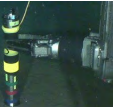
海底での地中温度の測定
