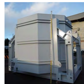
大型氷の作製用のタンク (直径3.2m x 高さ3m)
