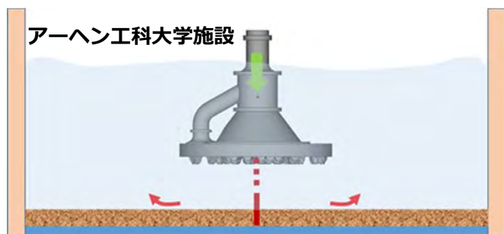
掘削時の土粒子拡散試験
