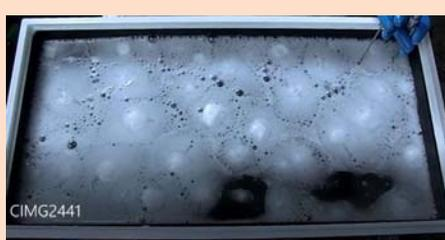
温水加熱によるMHのガス化
