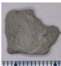
本委託研究で分析中のコア試料に含まれていた炭酸塩鉱物。周囲の泥質堆積物は、14wt%のCaCO<sub>3</sub>を含む。
