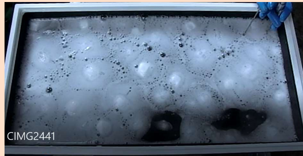
温水加熱によるMHのガス化 (MH分解実験の様子)
