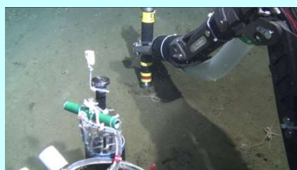
海底熱流量 測定装置 (SAHF)
