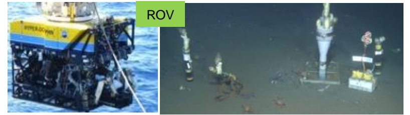
ROVと海底設置観測装置 (2014~2015年度)
