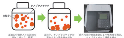
図2 土壌中ナノプラスチック濃度測定の流れ
