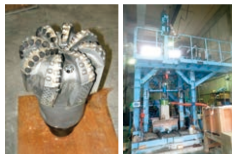
図1 PDC ビット (左) と室内掘削試験装置 (右)
