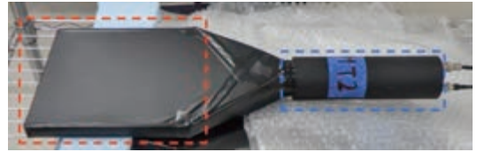
図1 検出器(プラスチックシンチレータ(赤点線)・光電子増倍管(青点線))
