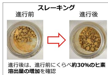
図2 物理的風化（スレーキング）と溶出特性の同時評価
