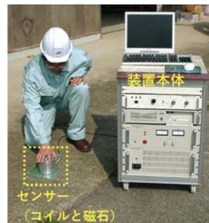
図1 磁気共鳴スキャナーを用いたコンクリートのスキャン風景(イメージ)
