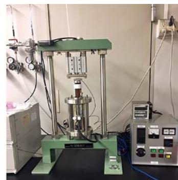
図1 上載圧荷重式乾湿繰り返し溶出試験装置
