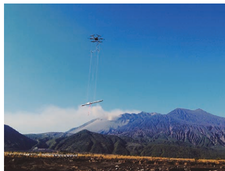
ドローン吊り下げ飛行による 電磁探査測定の様子（鹿児島県桜島）
