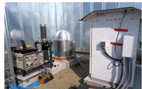
図2 苫小牧サイトにおける超伝導重力計(中央)と絶対重力計(左)の並行観測。
