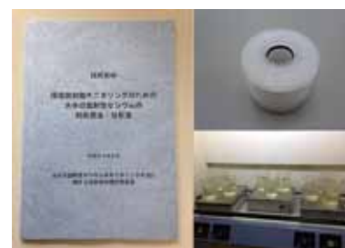
図1 精度評価試験で使用した濃縮技術 (左: 技術資料、右: PB フィルターカートリッジ法、右下: 蒸発濃縮法 (東北農研申氏提供))
