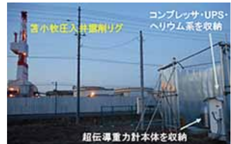
図1 苫小牧サイトの高精度重力モニタリング観測点(左後方はCO 2 圧入井掘削リグ)。
