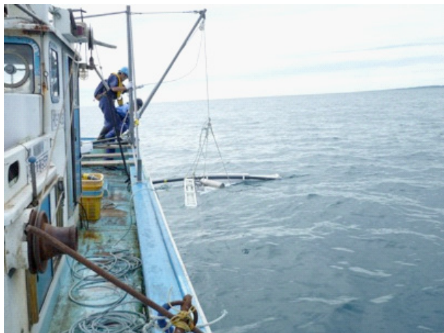
沿岸・浅海域海底電磁探査における電磁場受信器の投入作業風景
