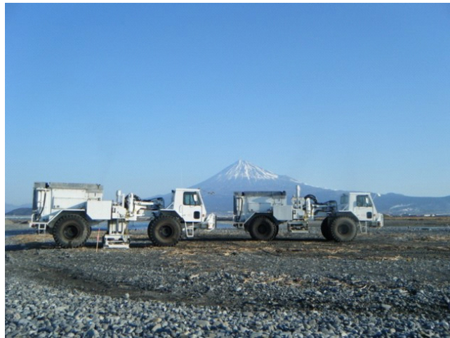
富士川河口断層帯の反射法探査 パイロサイズ車両による発震風景
