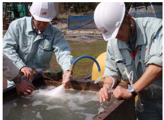
温泉掘削現場での水溶性天然ガスの採取 (産総研オープンラボ2012カタログより)
