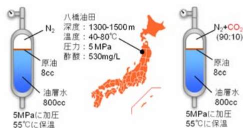
図1 現場（左）とCO 2 地中貯留後（右）の油層環境を模擬する高温高压培養実験
