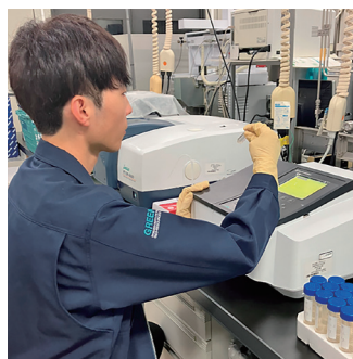
分光光度計を用いてナノプラスチック濃度を測定する土田研究員
