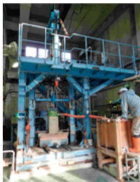
掘削ビットの室内性能評価試験
