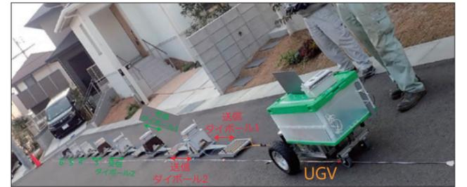
▲舗装路面上からの探査が可能な高周波交流電気探査システム
