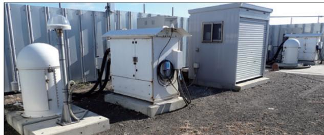
▲高精度連続重力モニタリング手法の研究：CCS 大規模実証試験小牧地点において測定中の超伝導重力計（左右両端）
