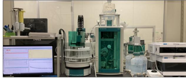
▲金属元素の安定同位体比分析のための自動元素分離装置
