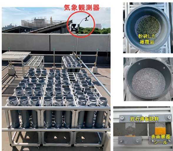
図6 屋上定点での長期風化実験
