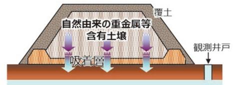
図 吸着層工法の模式図
