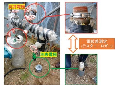
図2 電位観測システムの設置イメージ
