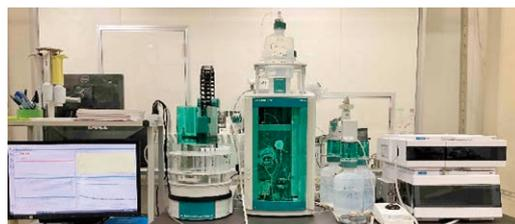
図 5 自動元素分離装置 (IC-FC)
