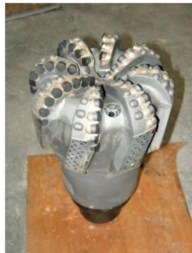
図 室内掘削試験で使用した PDC ビット (ビット径216 mm)
