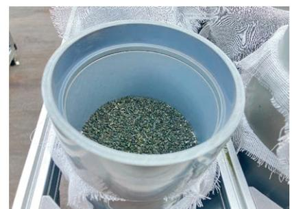
図2 反応容器中で風化進行中の岩石試料
