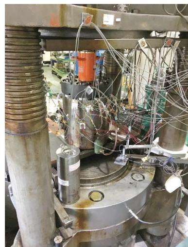
図 1 室内注水試験に用いた産総研設置の油圧式三軸圧縮装置
