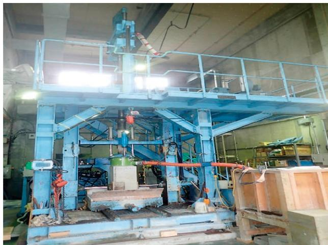
図3 大型室内掘削試験装置
