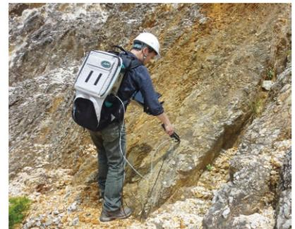
図2 野外分光計を用いた反射スペクトル測定の様子
