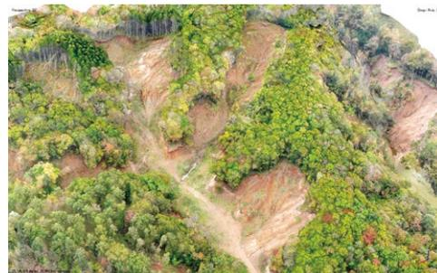
図 調査地域で見られる崩壊地および崩壊堆積物の例
