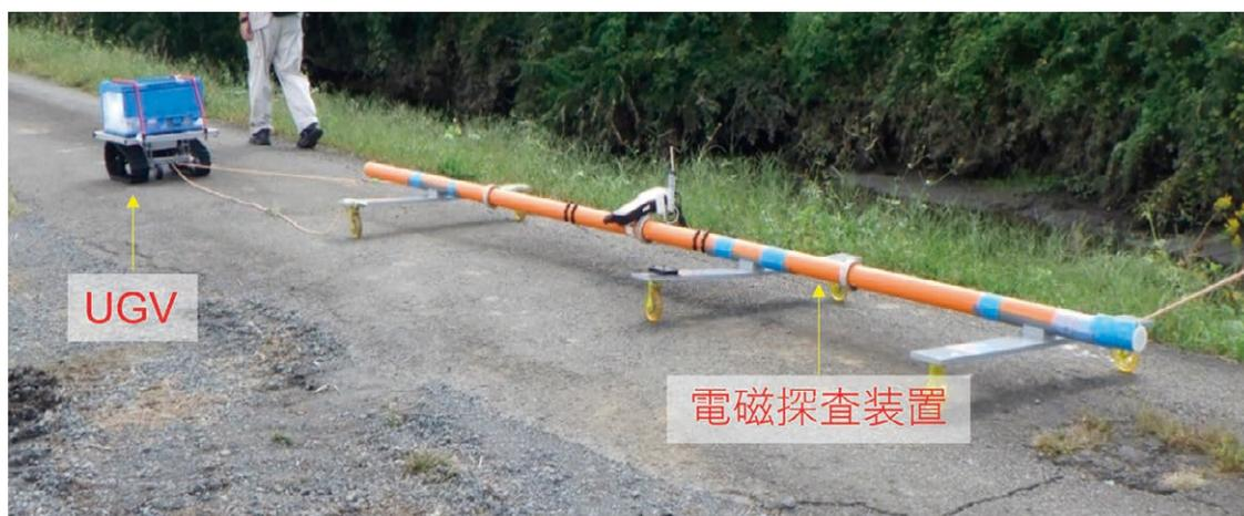
図 3 UGV 牽引によるマルチコイル型電磁探査システムを用いる測定の様子。
