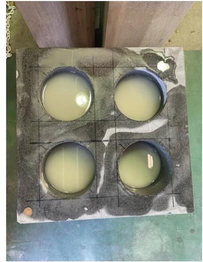
図 室内試験で掘削された岩石試料
