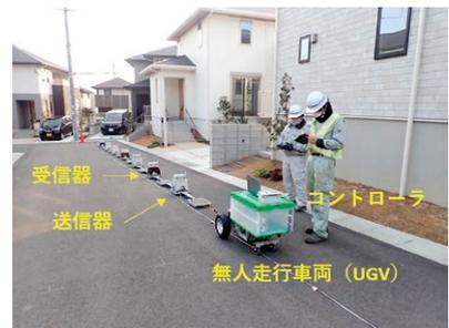
図 1 非破壊電気探査の様子: UGV により測定器と電極を牽引し、非破壊で地下を探査する
