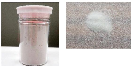
図7 レアアースを含有するリン酸石膏(左)回収されたレアアース精鉱(右)
