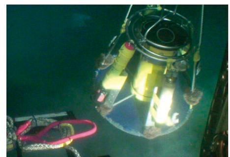
図2 遠隔操作型無人探査機を使用した観測装置の回収作業
