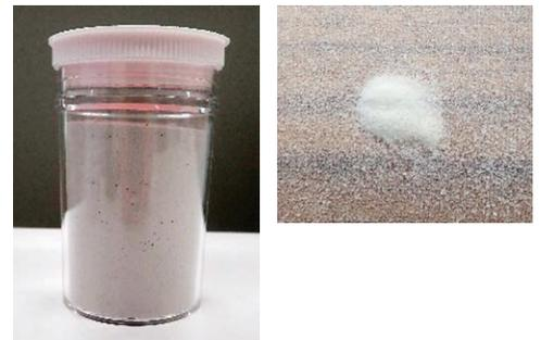
図 レアアースを含有するリン酸石膏(左) 回収されたレアアース精鉱(右)
