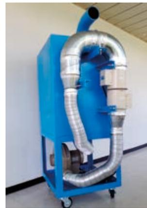
図2 ハウス栽培用除湿装置
