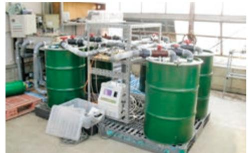
図1 二酸化炭素回収供給装置
