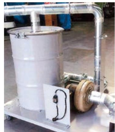
図1 熱供給型除湿装置
