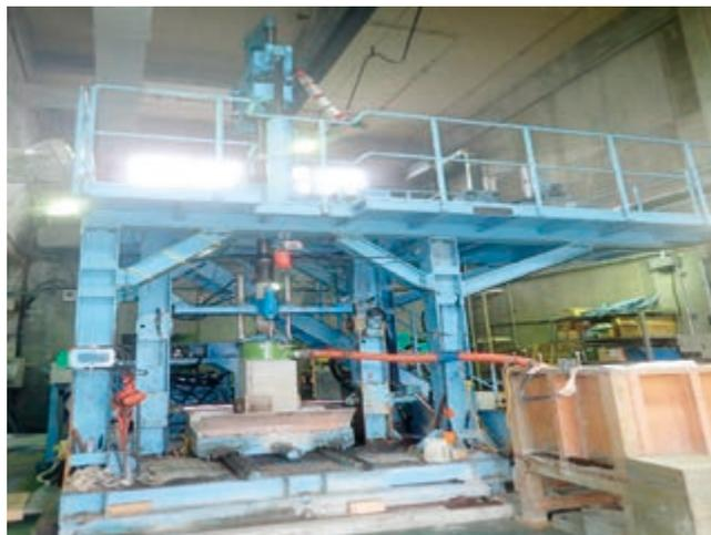
図3 大型室内掘削試験装置
