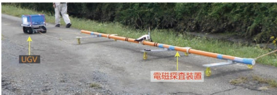
図4 UGV牽引による電磁探査測定の様子。
