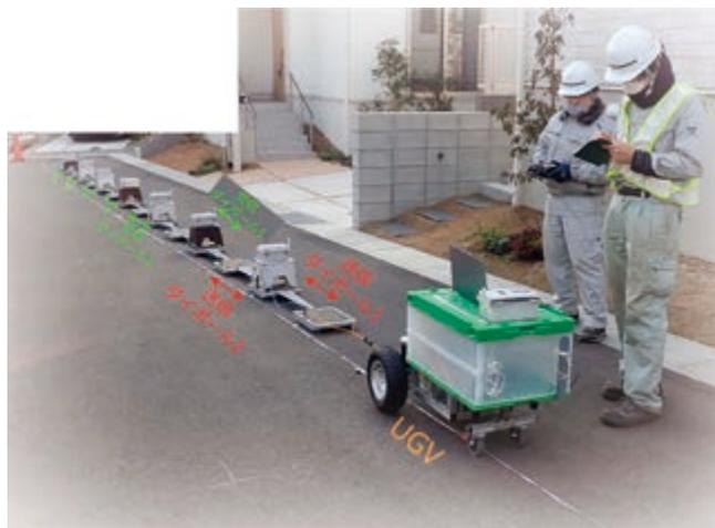
図 3 複数送信器を用いた、高周波交流電気探査 (送信電極切り替え方式) の様子。
