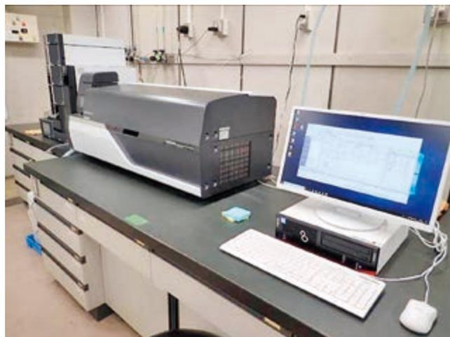
写真 2 液体クロマトグラフ質量分析計
