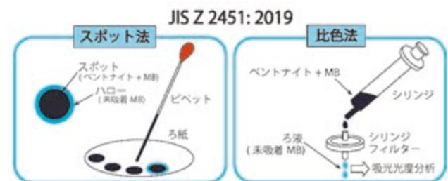
図2 メチレンブルー吸着量の測定方法
