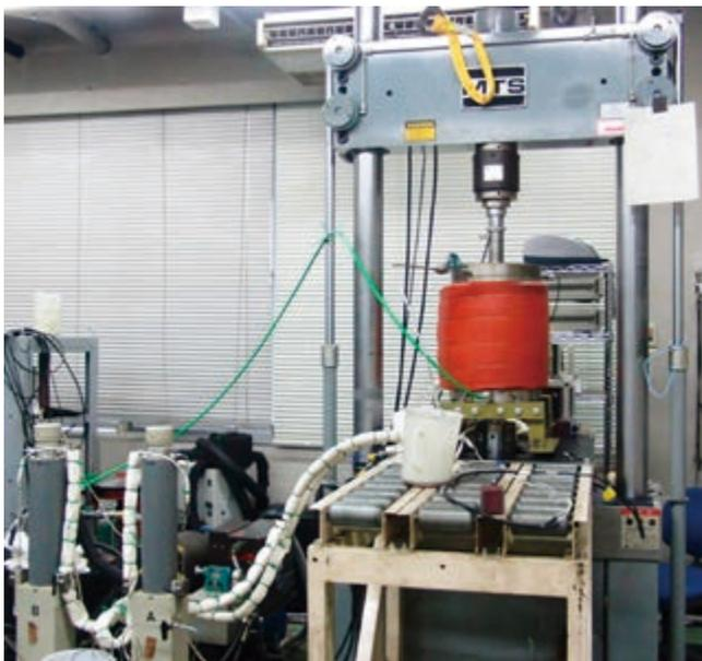
図2 岩石透水・透気試験装置
