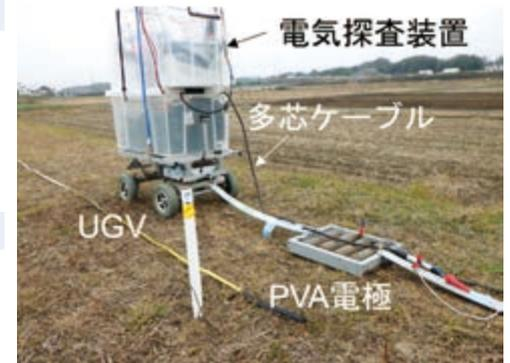
図 1 UGV+PVA 電極を用いた測定システム
