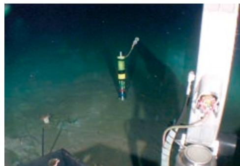
図1 堆積物の温度を計測するための地中温度計
