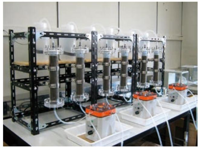
図6 上向流カラム通水試験方法
