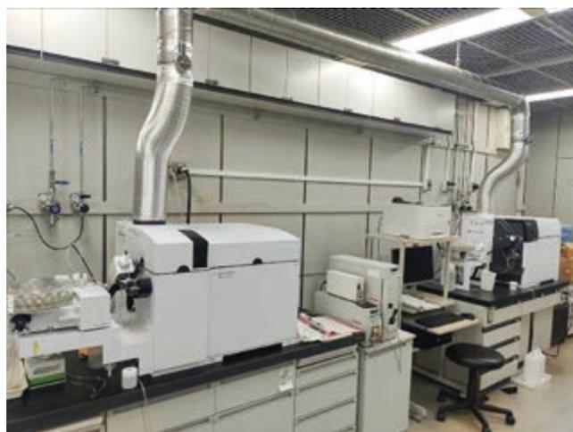
写真 3 誘導結合プラズマ質量分析計（ICP-MS）
