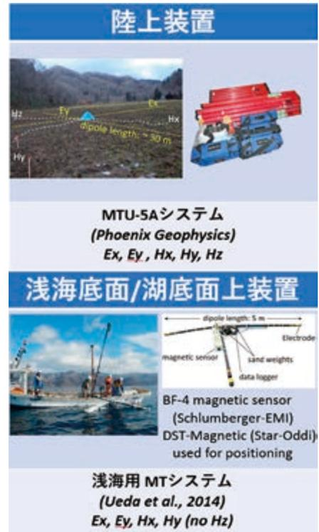
図1 陸域・海域・湖域調査に対応可能な広帯域MT法電磁探査システム
