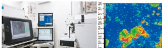
図3 レーザーアブレーション誘導結合プラズマ質量分析計（LA-ICP-MS）の様子（左）と希土類元素鉱石中のルテチウム分布（右）
