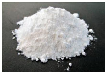
図2 比表面積の大きいアルミノケイ酸塩からなる人工の鉱物材料(ハスクレイ)
