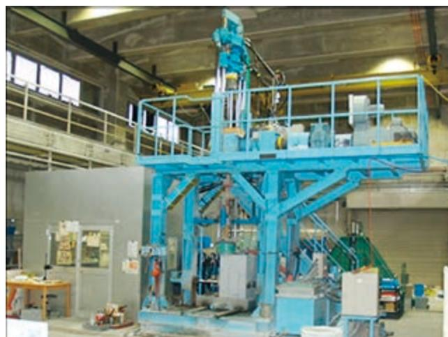
図 6 産総研所有の室内掘削試験装置
