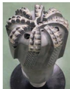
図 5 PDC ビット（ビット 7）の外観
