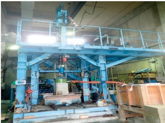
図3 大型室内掘削試験装置
