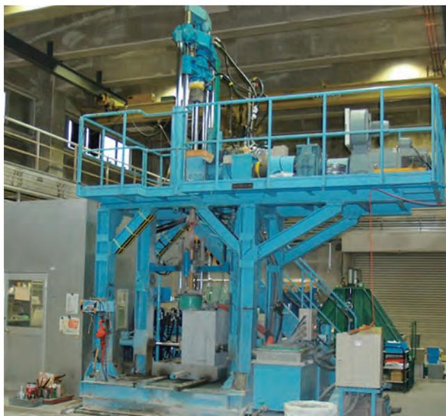
図3 室内掘削試験装置
