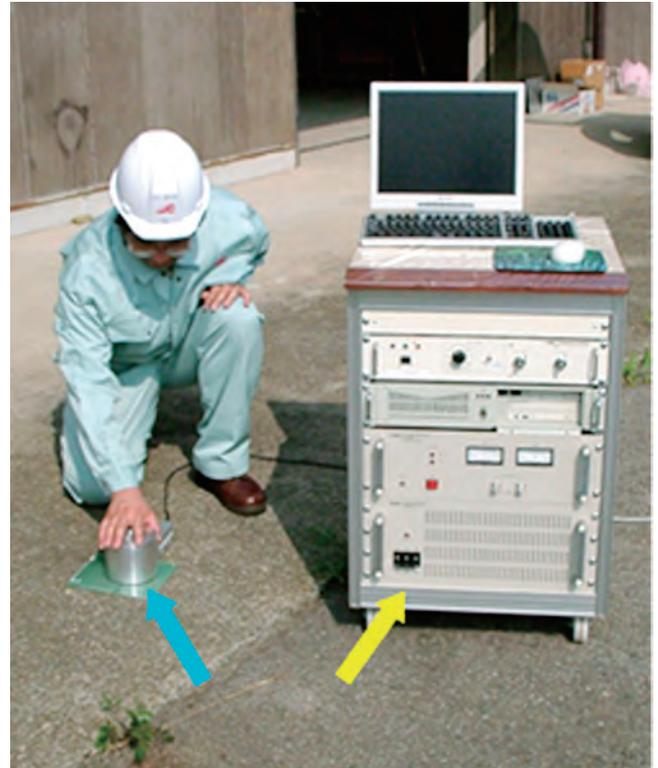
図1 片側開放型NMRによるコンクリートの計測風景（イメージ）。水色矢印は、センサーユニット（永久磁石と高周波コイル）。黄色矢印は、NMR分光器本体。
