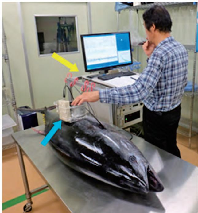
図2 片側開放型 NMR によるクロマグロの計測風景。水色矢印は、センサーユニット（永久磁石と高周波コイル）。黄色矢印は、NMR 分光器本体。
