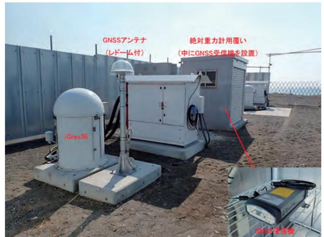
図1 苫小牧重力観測点の外観(手前および奥にある上部が半球状のエンクロージャ内に超伝導重力計を設置)
