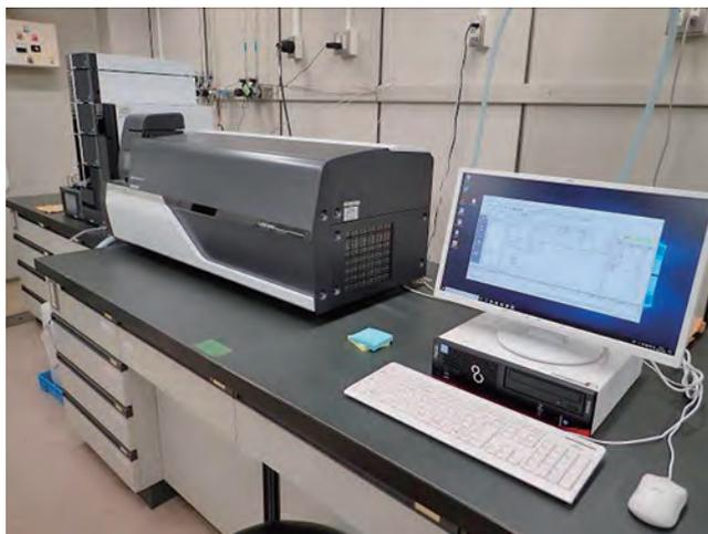
写真3 液体クロマトグラフ質量分析計
