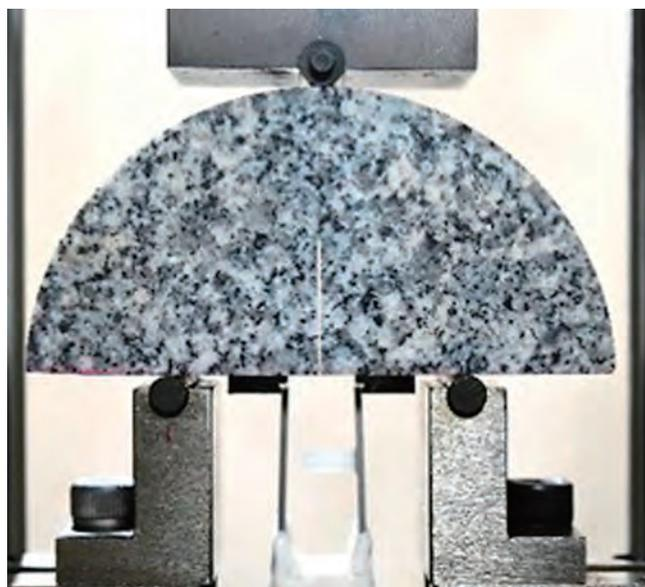
図5 SCB試験片を試験機に設置した様子
