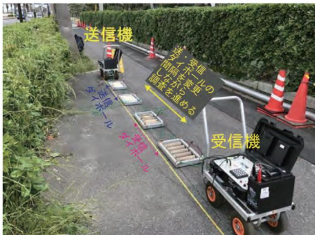
図3 高周波電気探査装置の外観。水を含ませた PVA 電極の一对から電極を流し、他の一对の電極で電位を計測する。送信・受信ダイポールの間隔を広げることにより、深部を調査することが可能となる。
