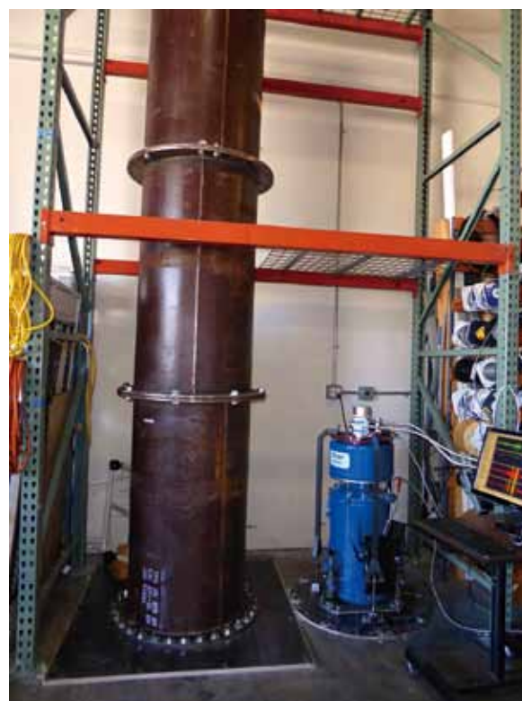
図3 超伝導重力計の鉛直配置並行測定実験
