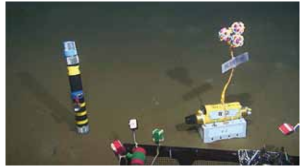
写真1 ROVによる海底地殻熱流量調査
