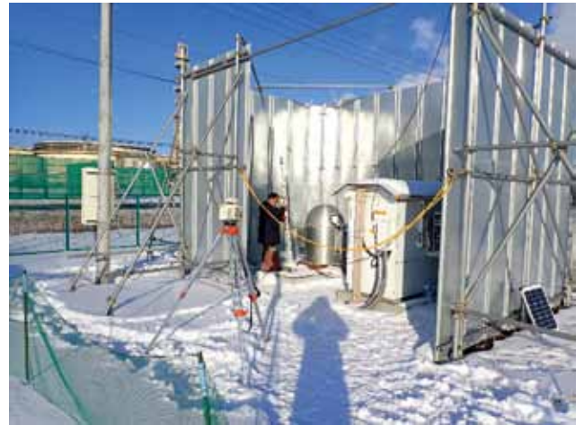
図 1 苫小牧実証試験サイトにおける重力測定
