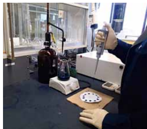
従来型のメチレンブルー吸着量測定の様子
