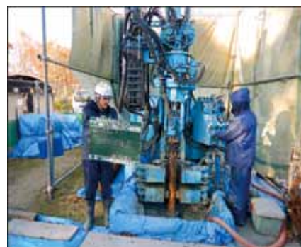
図1 ボーリングによるコア試料採取
