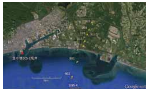
図 1 苫小牧沿岸域における MT 法探査の測点配置図。陸域 5 測点 (101~105) と海域 2 測点 (901と902) の配置。
