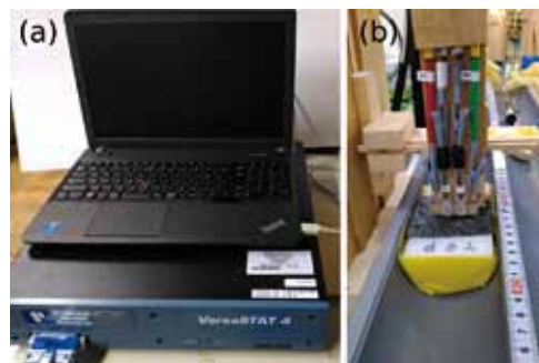
図 1 船上 IP 特性システム。(a) 高性能電気化学測定器 (下部) は PC により制御される。(b) プローブを用いた IP 計測の様子。
