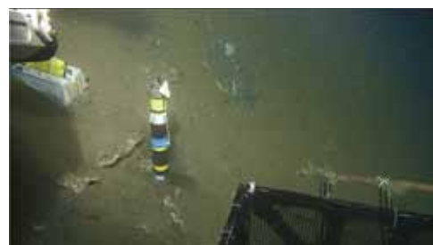
海底下温度を計測するための地中温度計
