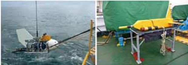
図5 曳航型海洋 CSEM 法探査システムの電流送信機 (左) と電場信号受信器 (右).
