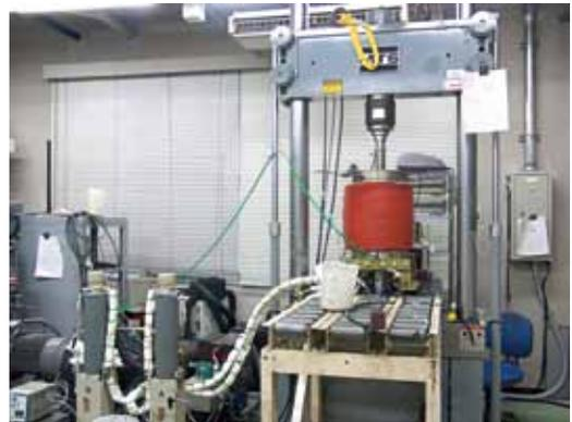
図2 三軸岩石透水(気)実験システム差圧下、岩石の浸透率・ひずみ・弾性波速度等を同時に測定
