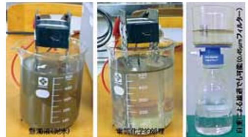
図1 電気化学的手法による洗浄水（泥水）の処理技術
