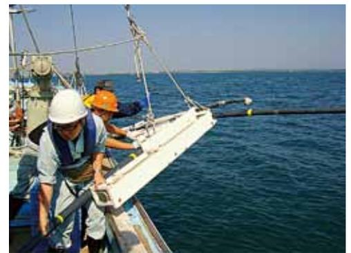
苫小牧沿岸域における浅海域電磁探査システムの中投下の様子。
