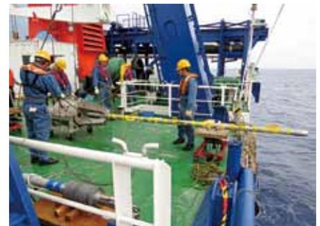
熱物性計測用の海底堆積物採取
