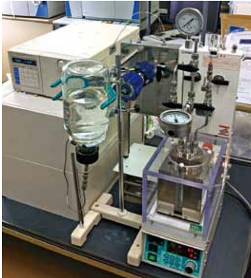
図1 当研究グループで構築した高静水圧培養システム。砂を充填して孔隙環境を模擬することもできる。
