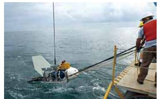
曳航型人工信号源電磁探査法の電流送信源。
