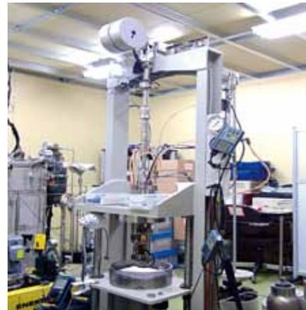
図3 三軸岩石クリープ実験システム
