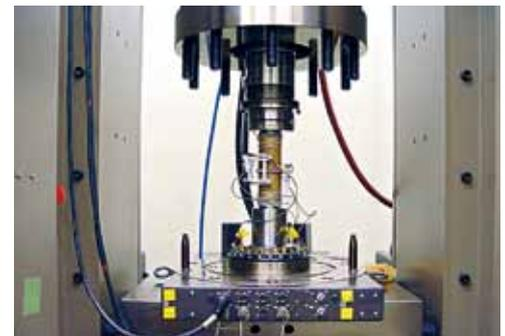
写真1 軸方向伸び計と周方向伸び計が装着された供試体がMTS社製岩石コンクリート試験機にセットされた状態
