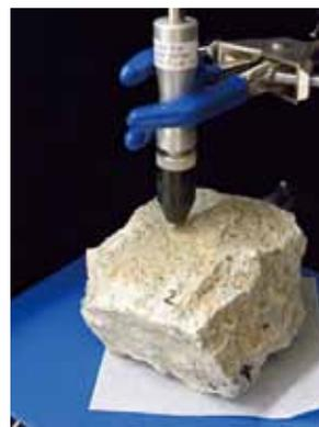
鉱石の反射スペクトル測定
