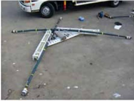
図8 浅海用海底電磁探査装置.
