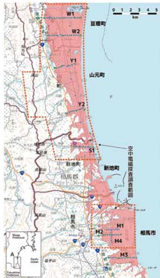
図2 津波被害による地下水汚染把握のために実施した電気・電磁法調査地域広域図。各測線はアルファベット（W：亶理，Y：山元，S：新地，M：松川浦（相馬市））と数字により測線番号として識別する。（国土地理院10万分1浸水範囲概況図14より，薄赤色が津波浸水範囲を示す）（上田ほか，2014）.
