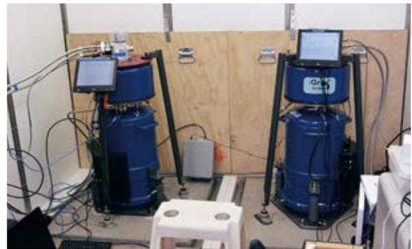
写真1 FWUにおける超伝導重力計による高感度連続測定。平成26年5月末より新たに導入した超伝導重力計を追加して、並行測定を開始した。
