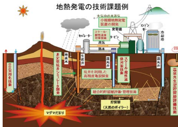
図2 地熱発電の技術開発課題例。江原 1) が挙げた6課題に温泉との共生技術を追加したもの。地熱発電所の図は日本地熱開発企業協議会作成。
