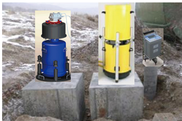
写真1 基点に構築した重力計測用基台(写真)と、重力計測のイメージを合成したもの。左から連続観測用超伝導重力計、絶対重力計、可搬型相対重力計。
