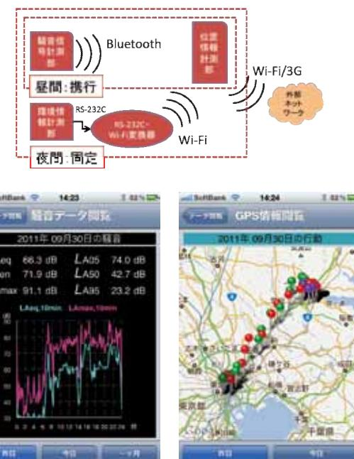
図3 開発中の自律型収集システムの機器構成と、ある被験者の一日の行動パターンと曝露された環境騒音データの実測例
