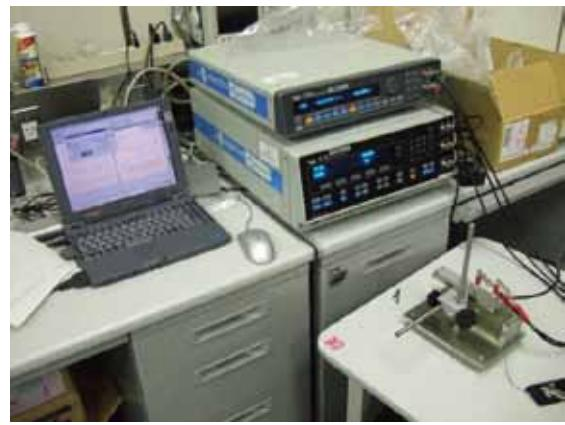
写真 2. 複素比抵抗の測定システム
