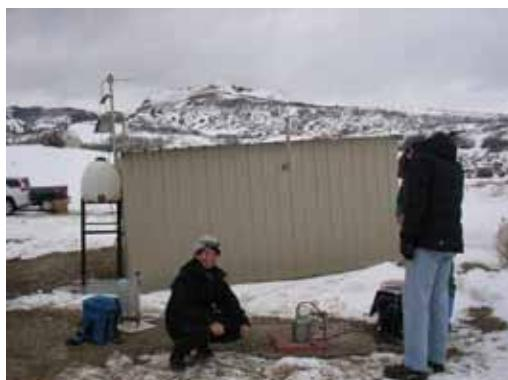
写真 1 : 2011 年 2 月現地調査における測定。左側青いバッグ脇の銀色の計器が CG5 可搬型相対重力計。写真中央の円筒型計器が CMG40T 地震計。中央の小屋内に CO<sub>2</sub> 圧入井に転用予定のメタン生産井がある
