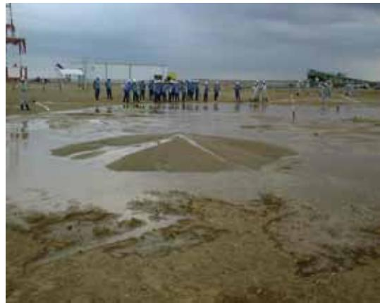
図6 発破液状化実験によって生じた噴砂
