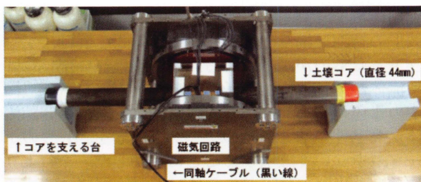
図 8：核磁気共鳴分析装置(土壌コアを計測中)
