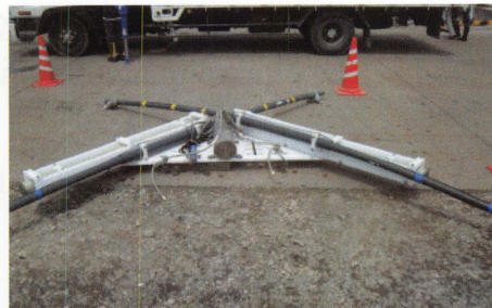
図 2：開発中の海底電磁探査装置の外観
