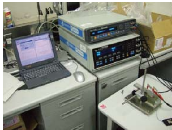
写真 2. 複素比抵抗の測定システム
