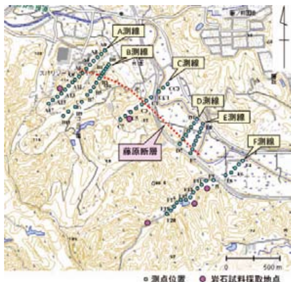
図 11. 藤原断層における CSAMT 法測線の位置(鈴木ほか, 2011). 送信源は測線 F から南東に約 5.5km 離れた場所に設置し, 電流ダイポール長は約 2km である。
