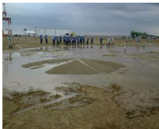
図6 発破液状化実験によって生じた噴砂
