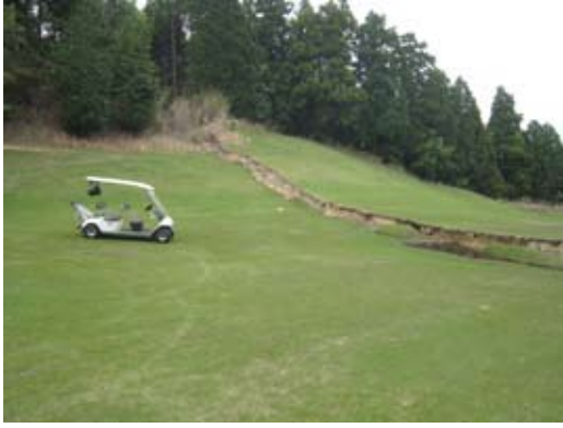
図 6. 4 月 11 日の余震で発生した藤原断層相当断層北端近くの地形変位(5 月 16 日撮影). 右が北東方向で, 正断層型の変位(鉛直約 80cm)を示す. CSAMT 法の B 測線に当たる.
