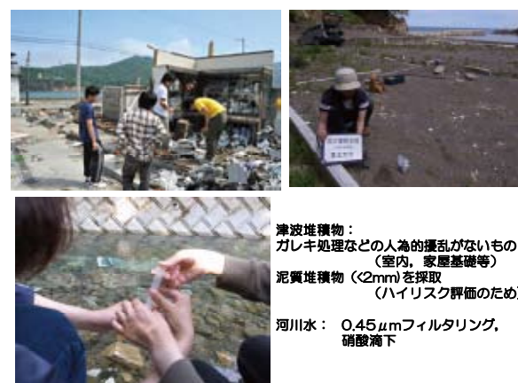
図 4 津波堆積物、河川水のサンプリング
