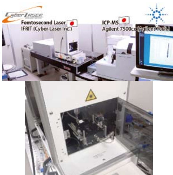
写真4 鉱物資源研究グループの LA-ICP-MS システム
