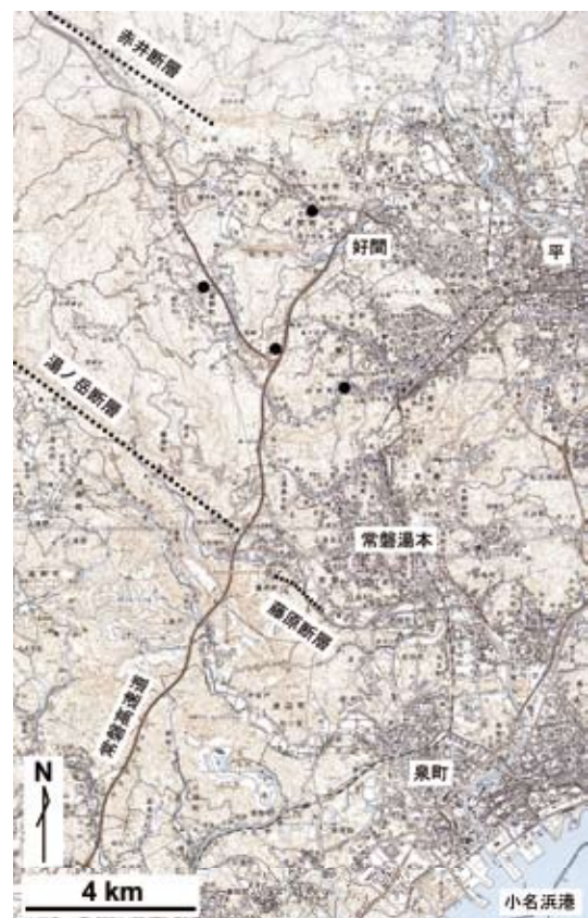
図 1. いわき市における調査位置図。破線は推定断層、ただし、藤原断層の破線は今回の地震で出現した地表変位箇所を繋いだもの。黒点は地震計設置位置。国土地理院 5 万分の 1 地形図「平」、「小名浜」を使用。
