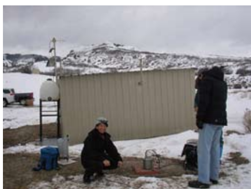
写真 1：2011 年 2 月現地調査における測定。左側青いバッグ脇の銀色の計器が CG5 可搬型相対重力計。写真中央の円筒型計器が CMG40T 地震計。中央の小屋内に CO 2 圧入井に転用予定のメタン生産井がある
