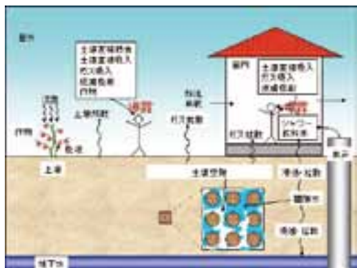
図 1 スクリーニングモデル GERAS-1 の構造
