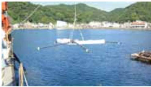
図 2：海底電磁探査装置の動作試験の様子
