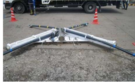
図 2：開発中の海底電磁探査装置の外観
