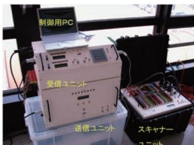
図 10：マルチ送信比抵抗探査装置の試作 2 号機。同時送信 8ch、受信 8ch で 64 個のデータを約 3 秒で取得でき、毎分 1200 点のデータを取得可能である。
