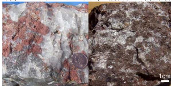
写真2 トアレイク鉱床の希土類鉱石。軽希土類に富む鉱石(左)の他に、重希土類に富む鉱石(右)が産出するため資源として重要である。
