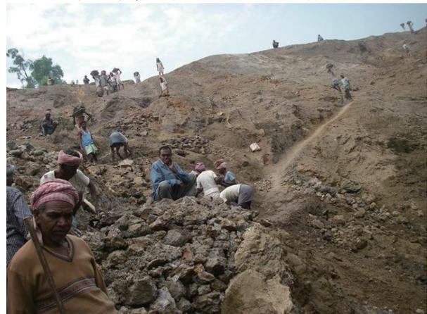
第2図. Beldih 鉱床の採掘風景。人力で採掘し、鉱石を積んだカゴを頭に寄せ運搬する。
