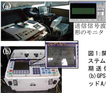
図 1: 開発した送受信システム。(a) GPS 時刻同期送信システム、(b) GPS 時刻同期 24 ビット A/D 受信システム。
