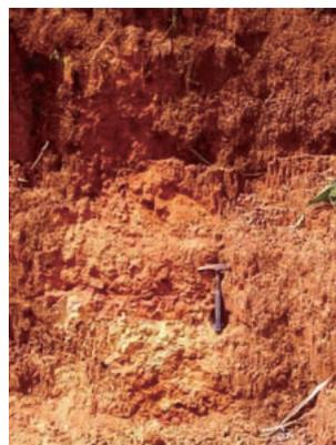
図 19 ハンマー位置より上の赤茶けた部分がボーキサイト、ハンマーの位置が粘土層、ハンマーの下の部分は粘土化砂岩。
