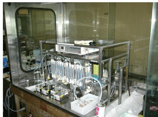
図1 ヘッドスペースガス中の $\text{CH}_4$ を $\text{CO}_2$ に変換しトラップするためのメタン酸化ライン
