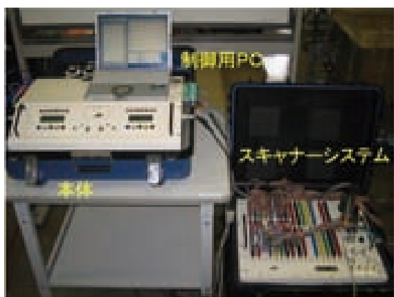
図6：マルチ送信比抵抗探査システムの本体とスカナーの試作装置。
