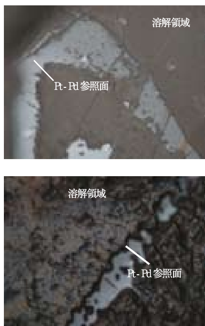
図4 長石の溶解表面 上図：低未飽和度、下図：高未飽和度
