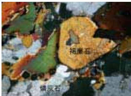
図 6 希土類元素に富むプーケット島北部 Khao Lam Ru 花崗岩の薄片写真. 希土類元素を含む褐廉石や磷灰石に富む.
