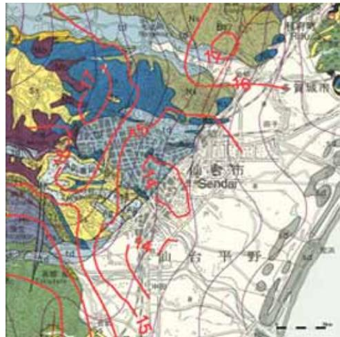
図 2 「仙台平野水文環境図」のコンテンツの一部。標高-50mにおける地下温度分布を示している。
