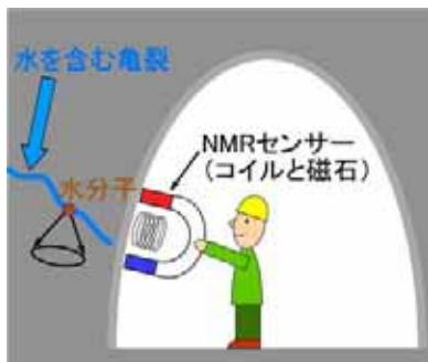
図9:NMR 物理探査装置によるトンネル壁の検査の概念図。磁石とコイルからなるセンサー単位で壁をスキャンすると、壁の内部の含水亀裂中のプロトンから NMR シグナルを検出できる。
