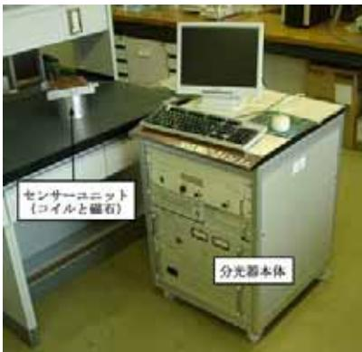
図8:現在開発中のNMR物理探査装置。ワゴンに載った分光器本体(トランミッターと制御用PCを含む)と、永久磁石とrfコイルからなるセンサー単位で構成されている。
