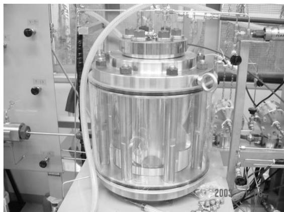
図3 開発した浸透率評価モジュール（ポリカーボネート製3重管透明容器）
