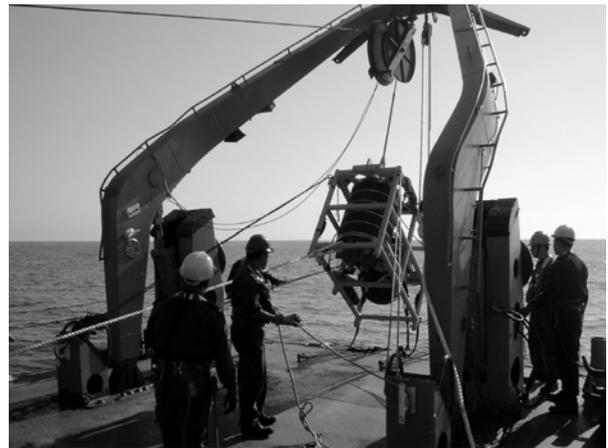
図3 チリ沖 Vidal Gormaz 航海で実施されたアメリカ海軍研究所(NRL)の深海曳航式地震探査装置DTAGSの投入風景
