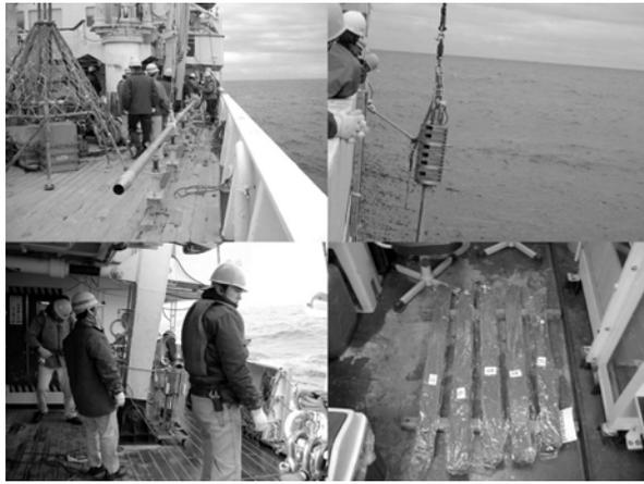
図7 ピストンコアの採取の様子
