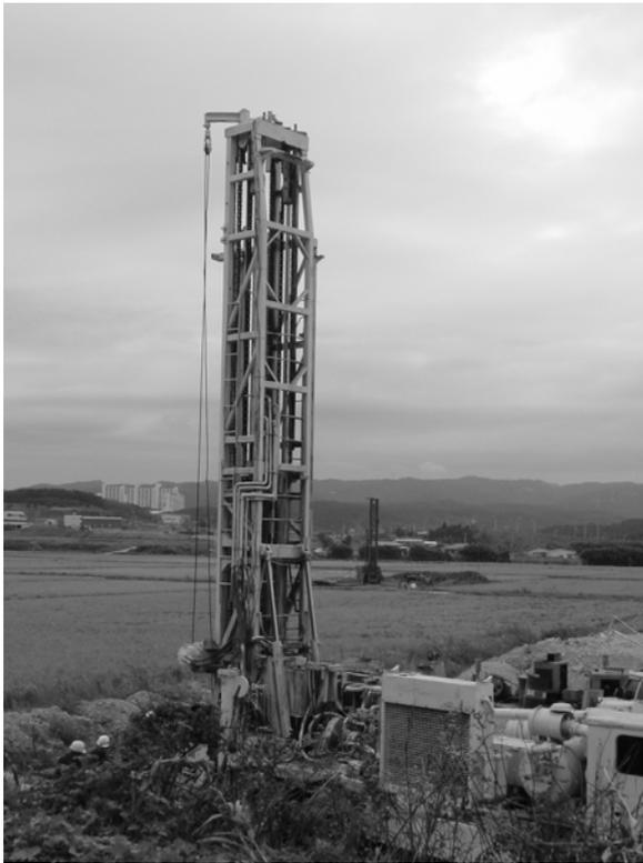
図6 韓国 KIGAM が浦項（ポハン）市に掘削中の2坑の1000m深パイロット地熱井。手前と向こう側に2つのリグが見える（2003年9月25日撮影）。
