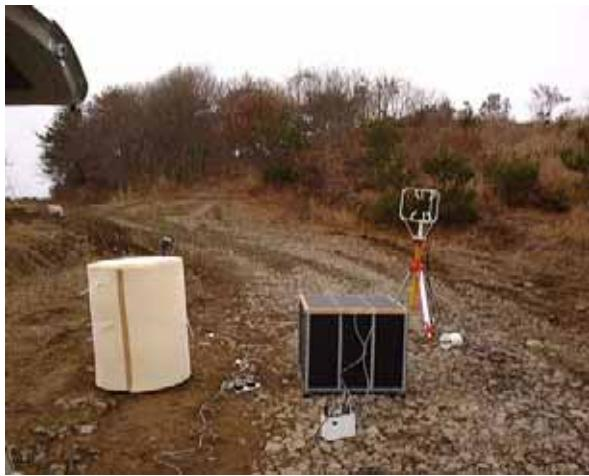
写真1: 試作した騒音計収容型ウィンドスクリーン
