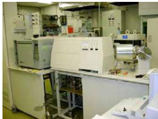
図1 ガスクロマトグラフ燃焼同位体質量分析計。
