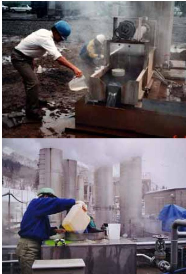
写真 1 1988 年肘折で最初に実施したトレーサ試験における生産流体採取風景と、写真 2 2001 年長期循環試験中の注入タンクへのトレーサ原液投入風景
