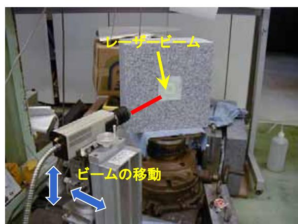
図 3. レーザードップラー振動計による弾性波動場計測実験。試料面に取り付けた圧電素子から弾性波を放出し、反対側の面で透過弾性波を観測する。
