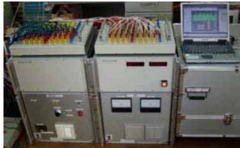
写真1 高出力多チャンネル電気探査装置
