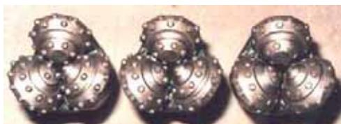
図1 掘削実験に用いたビット
