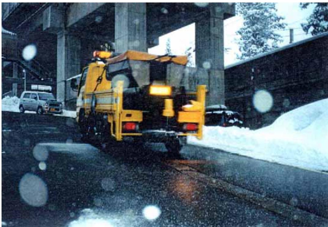
小型トラックによる凍結防止剤散布風景（路面の中央に消雪パイプが見える）
