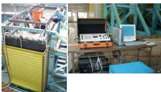
図1 大型土槽および液状化状態可視化装置
