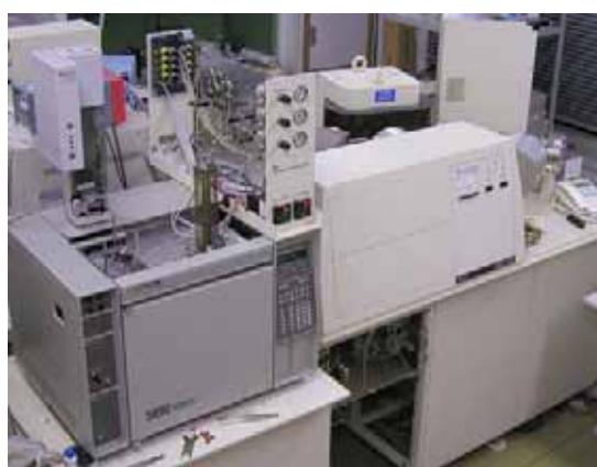
図4 ガスクロマトグラフ燃焼質量分析計
