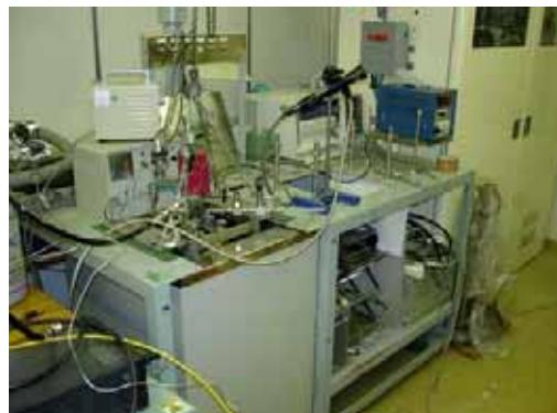
図2 ガスハイドレート合成実験装置
