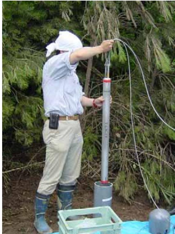
図4 高精度傾斜計の設置作業
