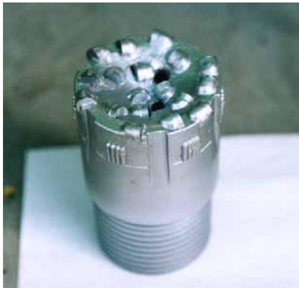
図 4 直径 66.0mm PDC 全断面ビット
