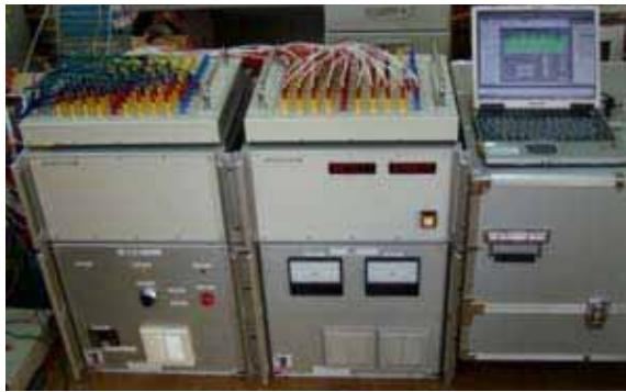
写真2 高出力多チャンネル電気探査装置
