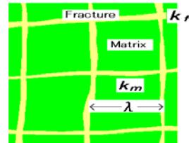
図2 界面動電現象による携帯電流は、岩石の浸透率でなく空隙率に比例するため、マトリックスの寄与が大きい。
