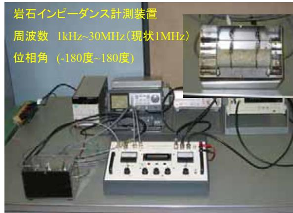
図1 試作した岩石インピーダンス計測装置
