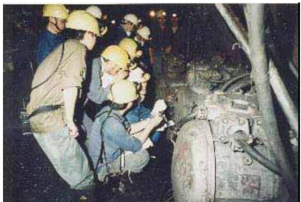
図7 マオケ炭鉱坑内での電気機器防爆性能点検
