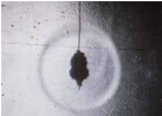
図1 水中衝撃波の可視化実験
