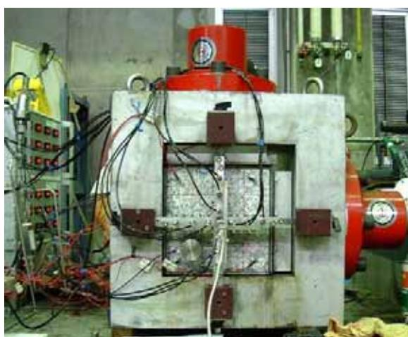
図1 人工き製造成用二軸荷重載荷装置
