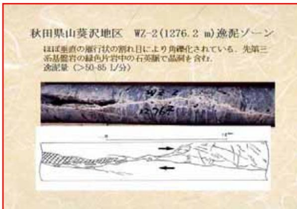
図1 透水性断裂の例
