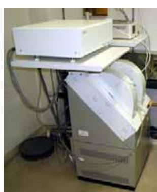
図1 ESR装置の測定部。電磁石、マイクロ波ユニット、試料キャビティで構成される。
