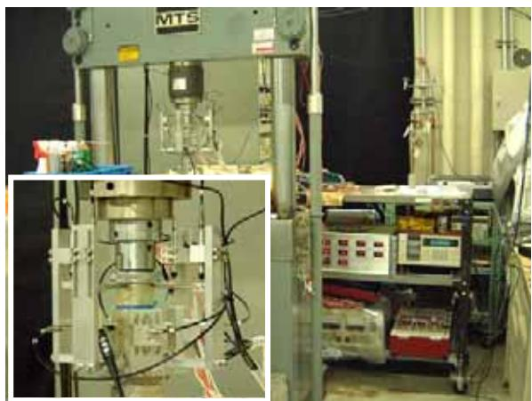
図 8 材料試験機による製作治具の較正
