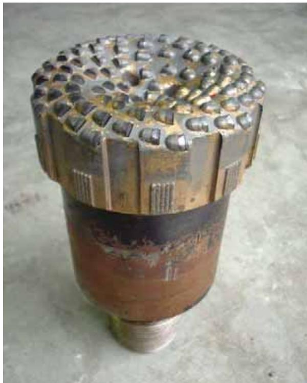
図 1 直径 142.88mmPDC 全断面ビット
