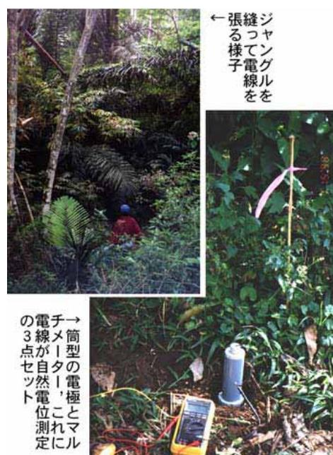
図3 フローレス島での自然電位測定
