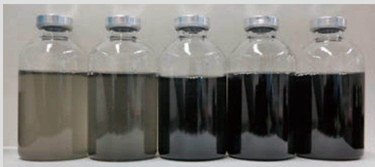
二価鉄濃度をパラメーターとした浄化試験の様子
