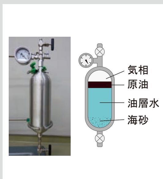
図 2 地下油層環境を模擬した高温高压培養実験
