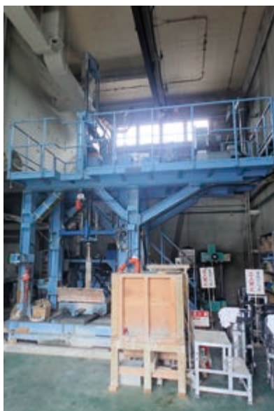
室内掘削試験装置
